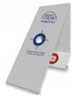
Wenn die Probenplatten dick sind, ist die Lichtkabine abzusenken um den richtigen Betrachtungswinkel zu erreichen. Am Besten verwendet man dafür einen 45° Probenständer. Bei dreidimensionalen Proben ist die Vorgehensweise entsprechend anzupassen, das ist je nach Formgebung nicht ganz einfach. Vor allem wenn der Standard eine flache Platte, die Probe aber dreidimensional ist.
